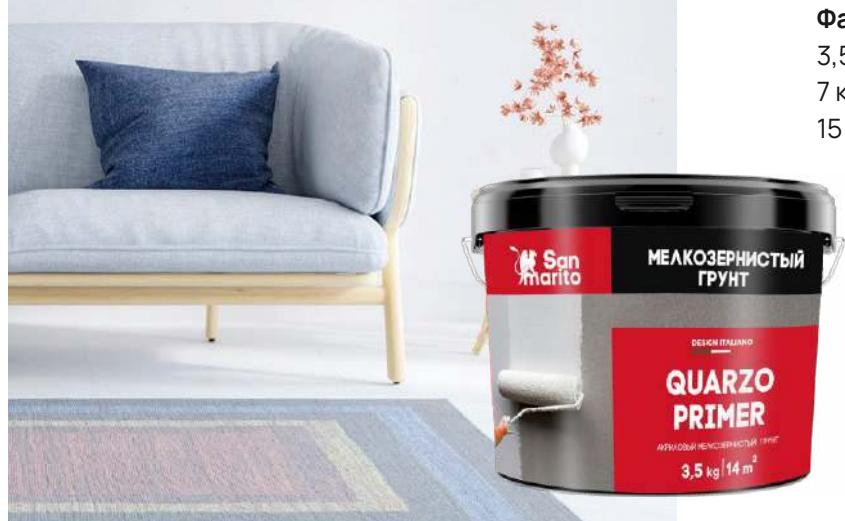
**Нанесение:** наносить на сухие, чистые поверхности валиком. Непрочные и пылящие основания прогрунтовать **Base Primer**. Перед применением **Quarzo Primer** тщательно перемешать, при необходимости разбавить водой не более 5%. Последующие работы производить после полного высыхания грунта.
