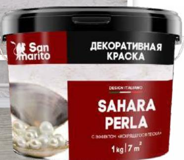
**Нанесение:** наносить на идеально ровную и прочную поверхность. Основания на базе гипсовых строительных смесей, слабые и мелящиеся основания укрепить грунтовкой **Base Primer**. Неровные поверхности выровнять шпатлевкой **Arte Mastice** и отшлифовать наждачной бумагой. Для идеальной адгезии нанести грунт **Base Concentrato** (в разведении 1:9). Для получения более качественного покрытия нанести декоративный грунт **Base Colore** (колерованный в цвет финишного покрытия).
